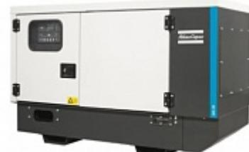
Дизельный генератор QIS 25 (230V) мощностью 16,4 кВт при основной нагрузке, имеет ёмкость топливного бака 55 литров и его топливная автономность при сто процентной нагрузке составляет 10,6 часа. Двигатель Kubota V2403-M-BG , объёмом 2,4 литров обеспечивает экономичную и, относительно, мало шумную работу генератора.
