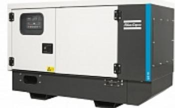
Дизельный генератор QIS 10 (230V) мощностью 7,2/8,2 кВт при основной нагрузке, имеет ёмкость топливного бака 55 литров и его топливная автономность при сто процентной нагрузке составляет 22 часа. Двигатель Kubota D1105-BG-50HZ, объёмом 1,12 литров обеспечивает экономичную и, относительно, мало шумную работу генератора.
