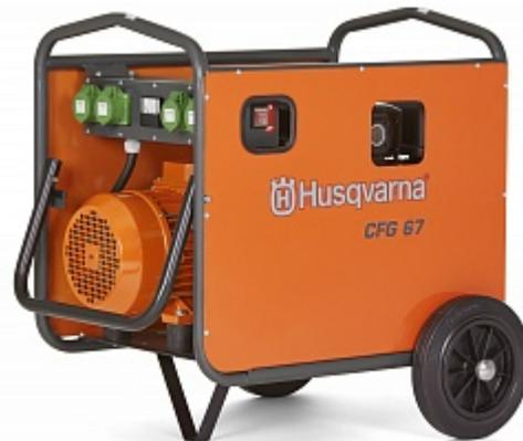
Подбор правильного вибратора осуществляется по принципу суммарного потребляемого тока вибраторами, он не должен превышать вырабатываемый преобразователем выходной ток. К примеру: CF25 вырабатывает ток в 25 А, следовательно он может питать два вибратора AX48, каждому из которых требуется 10А.
